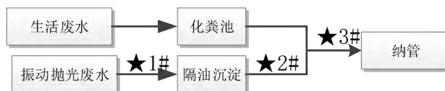
图 3-1 废水处理工艺流程
