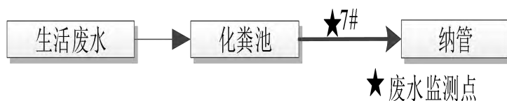
图3-1 生活废水处理工艺流程
