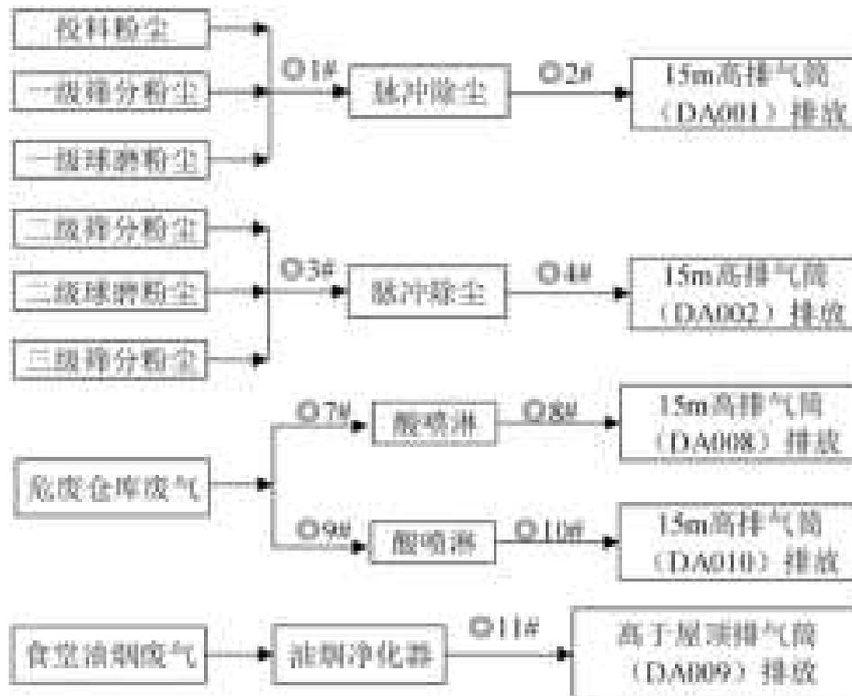
图 4.1-4 废气处理流程及监测点位示意图
